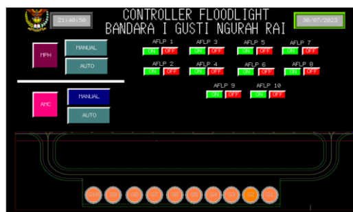
Gambar 7. User AMC mengambil alih kontrol remote dan menyalakan lampu mode manual
