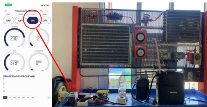
Gambar 11. Pengujian Kontrol Dan Monitor AC Sumber: Hasil Riset
